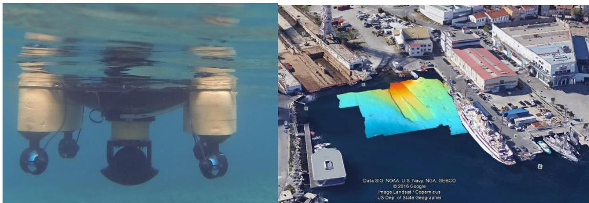
**Slika 6 Profiling sonar i rezultat hidrografskog mjerenja u luci**
